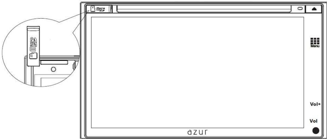
(2) 車のエンジンをかけACCをONしてください。本体の起動と同時にアップデートが開始されます。
