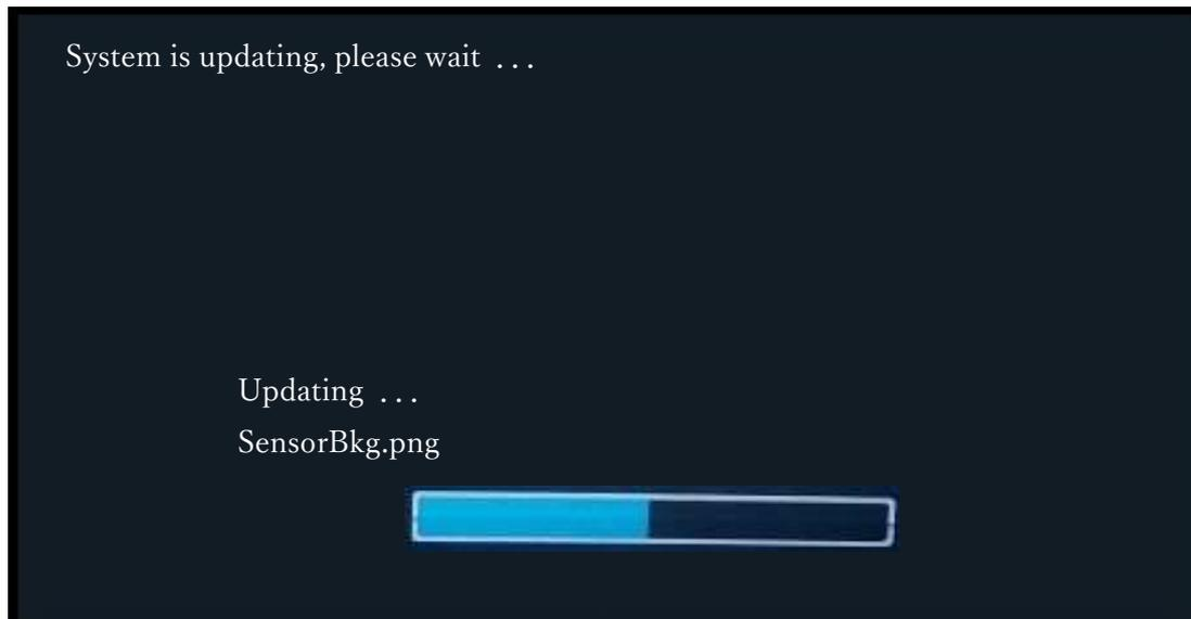
(4) アップデート開始し、しばらくするとFM/AM画面が表示されアップデートが完了します。車のエンジンを停止し、上記手順(1)でアップデートファイルの入ったmicroSDカードを抜いてください。これで作業は終了します。
