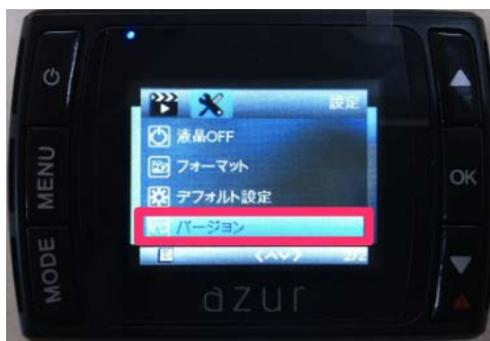
全般設定メニュー画面を開いたら、本体右側の上下ボタン（△ ▽）を押して、【画像 9】を参照し、「バージョン」にカーソルを合わせ、本体右側の「OK」ボタンで選択します。
