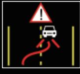
車両の速度が50km/hに到達し、車両が本来の車線から外れると、音声および画面表示で警告します。
